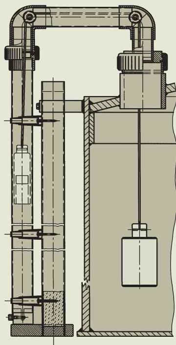
ter nicht geführt, daher kann er weder geklemmt noch verklebt werden. Somit ist seine einwandfreie Funktion gesichert. Ein eventuelles Auslenken des Schwimmers um 25 cm würde bei einer Behälterhöhe von 2 m lediglich eine Fehl Anzeige von weniger als 1% bewirken.
